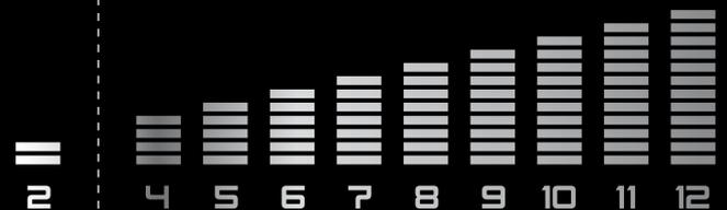
La régulation adaptative du niveau de protection règle de manière entièrement automatique le niveau de protection approprié dans la plage de 4 à 12. Cette tâche revient à un capteur de luminosité supplémentaire qui mesure l'intensité de l'arc électrique. Vous restez ainsi toujours parfaitement protégé, et ce quels que soient vos paramètres de soudage momentanés. Les adaptations manuelles ne sont plus nécessaires.
