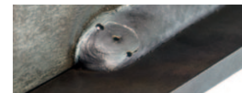
Avec remplissage de cratère final – excellente fin de cordon
