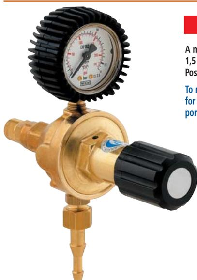
A monter sur canalisation avec pression de 6 bars mini à 20 bars maxi pour Oxygène et gaz neutre, ou sur canalisation avec pression stable de 1,5 bars maxi pour acétylène et pression stable de 4 bars maxi pour propane et autres gaz carburants. Entrée arrière 3/8 Gaz (existe en 1/2 mâle). Possibilité de montage sur support à clapet Réf. 060 260.
